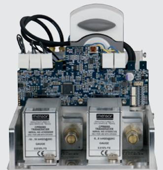
配置两个传感器的LPPump模块
